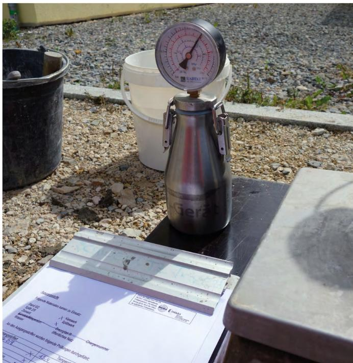
Bild 3: CM-Gerät zur Ermittlung der Restfeuchte (SCHWENK)
